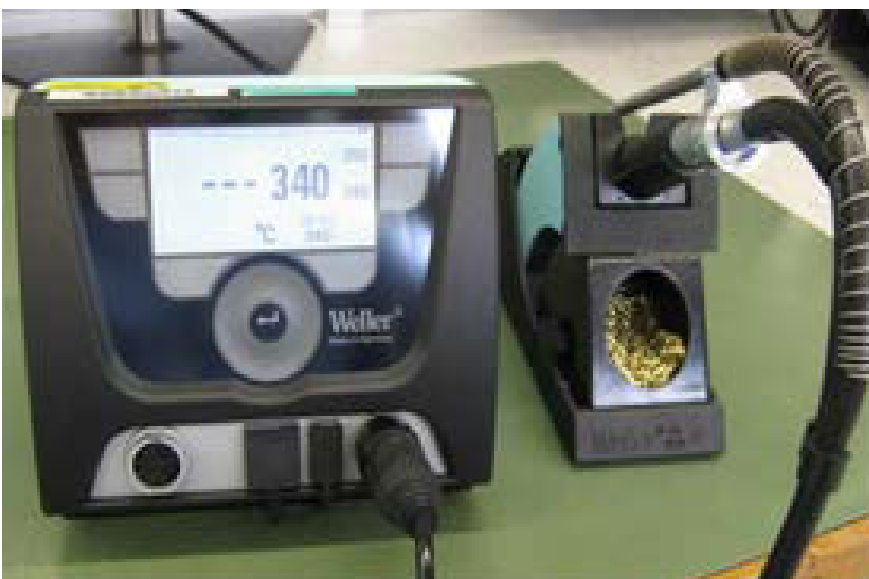
Abbildung 2 Bleifreies Kolbenlöten mit Lötspitze, Lötendraht und Absaugung
