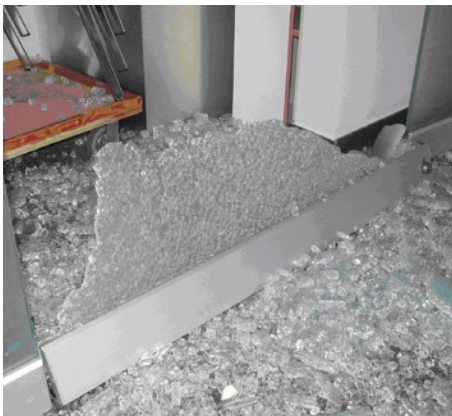
Abb. 1 Schollenbildung nach ESG-Bruch
