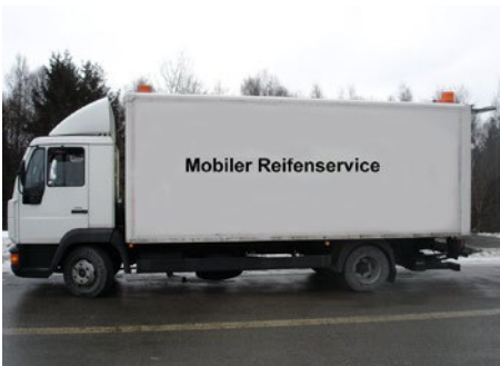
Abb. 5 Fahrzeug mit entsprechender Ausrüstung vornehmlich zur Behebung von Reifenpannen an Ort und Stelle (Sonstiges Kfz Werkstattwagen (SKW))
