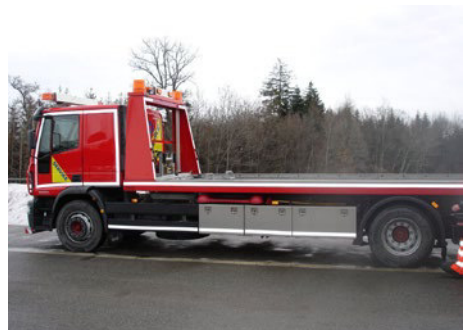
Abb. 3 Bergungsfahrzeug (LKW für Fahrgastbeförderung (LFB), mit Kran (LFBK))
