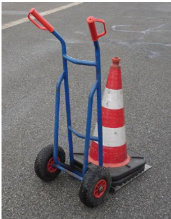
Abb. 11 Transportkarre für Leitkegel
