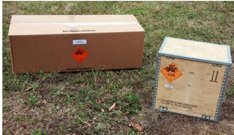
Abbildung 4: Versandkiste für Feuerwerkskörper aus Karton und aus Holz
