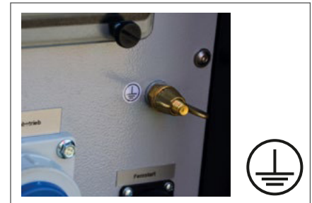
Abb. 2 Symbol 5019 „Schutzerdung“ nach DIN IEC 60417
