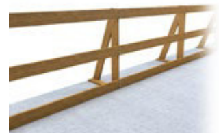
Abb. 6 Dreiteiliger Seitenschutz aus Holz
