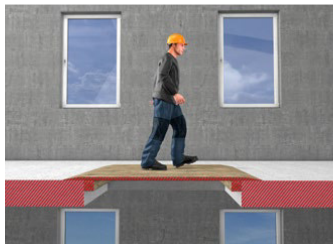
Abb. 8 Darstellung einer Bodenabdeckung im Schnitt
