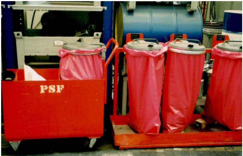
Abb. 7 Handwagen zum Transport von Ölbindemittel
