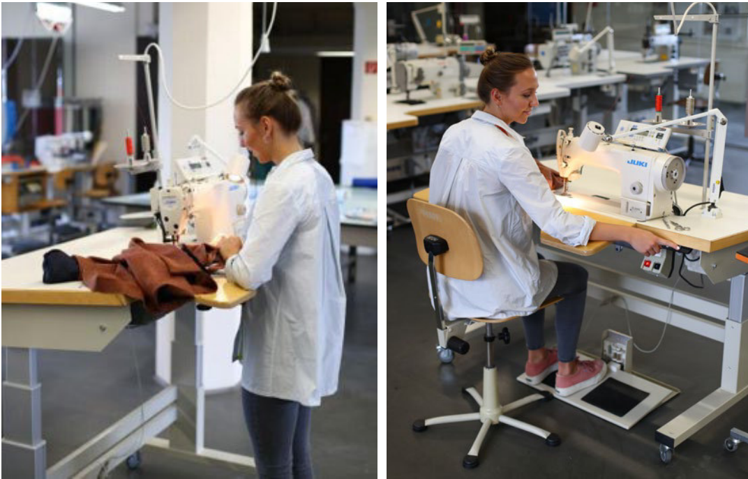
Abb. 2a N harbeitsplatz mit elektromechanischer Arbeitstischh henverstellung
