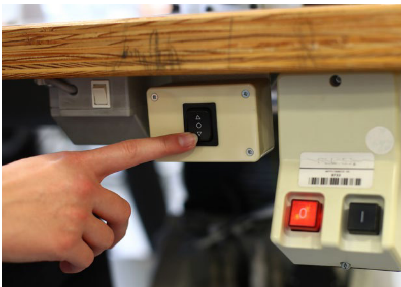
Abb. 2b Bedienelemente der elektromechanischen H henverstellung
