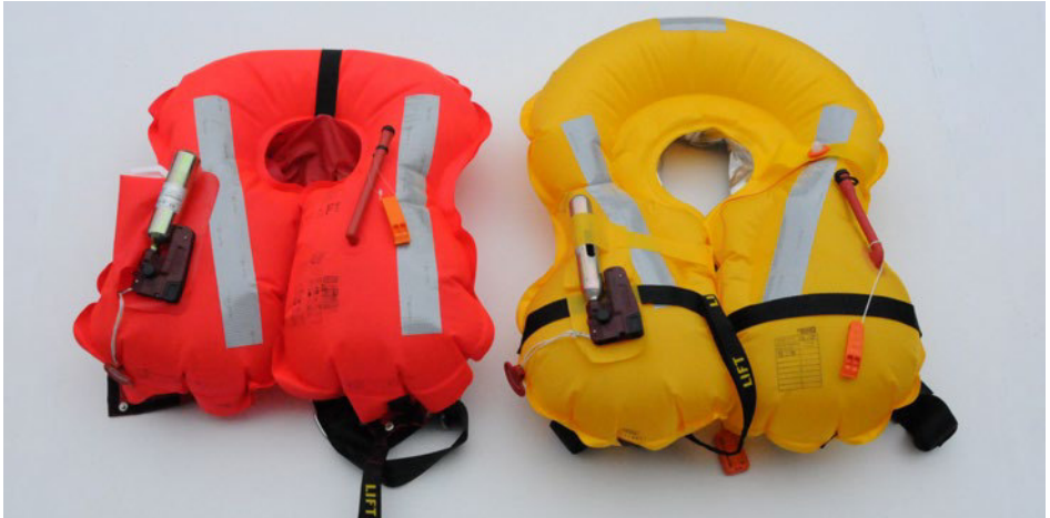
Abb. 3 Rettungswesten mit Standardauftriebskörper (links) und angepasstem Auftriebskörper (rechts) in ausgelöstem Zustand.
