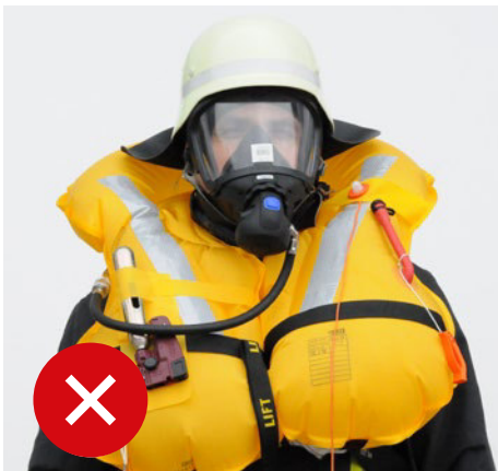
Abb. 6 a Rettungsweste in falscher Kombination mit Atemschutzgerät: Führung der Mitteldruckleitung über dem Auftriebskörper. Gefahr: Der Atemanschluss kann vom Auftriebskörper angehoben werden.
