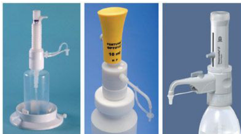
Abbildung 2: Dosiervorrichtungen für Flusssäure
